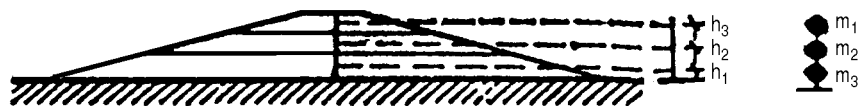
Hình 5-13. Sơ đồ quy đổi mặt cắt đập hình thang thành cột công sôn có khối lượng tập trung
