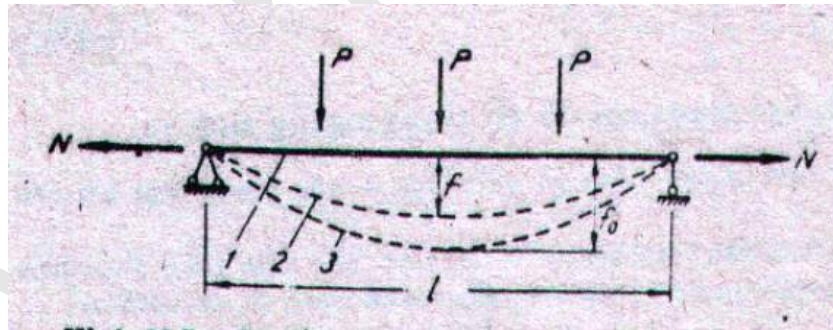
Hình 11-7 – Sơ đồ tính toán cấu kiện chịu kéo uốn : 1. đường trục cấu kiện khi chưa biến dạng ; 3. đường cong của trục do tải trọng ngang P sinh ra ; 2. đường cong của trục do tải trọng ngang P và lực dọc N sinh ra
