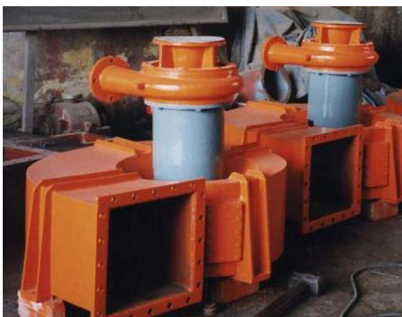
Hình 3. Bơm thủy luân buồng kín cột áp cao
