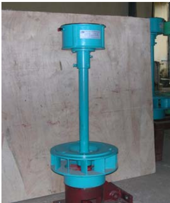
Hình 5. Tổ máy thủy điện cực nhỏ cho hộ gia đình
