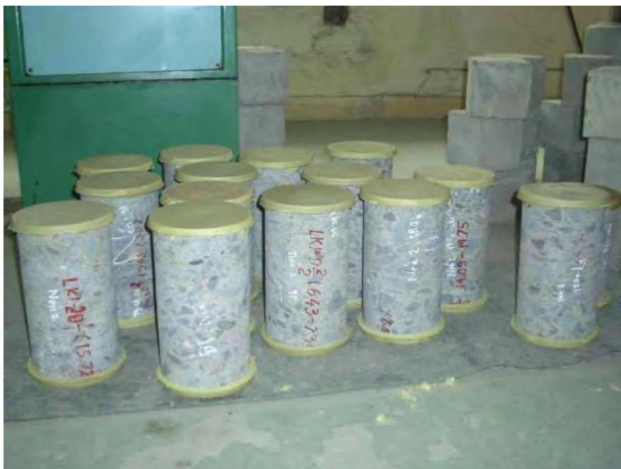
Cường độ RCC mẫu khoan lõi đập A-Vương R_n = 20-30 MPa
