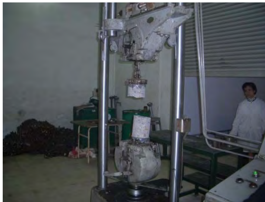
Cường độ kéo dọc trục mẫu khoan lõi đập A-Vương R_k = 0,70 - 2,0 MPa
