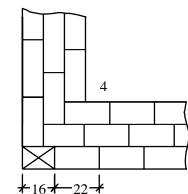
**Hình A.2. Sơ đồ xây tường 33**
