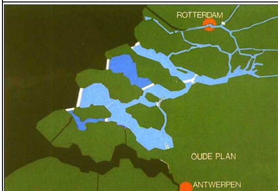
Đề án Delta Plan ban đầu. Tất cả các đê đều đóng. Màu xanh đậm là nước lợ. Màu xanh nhạt là nước ngọt
