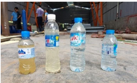
Hình 15: Từ trái sang phải: nước đầu vào, dầu ra với Q=5 \text{ m}^3/\text{h} ; 4 \text{ m}^3/\text{h} ; 3 \text{ m}^3/\text{h} .
