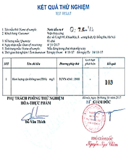
Hình 8: Độ đục =103 mg/l với Q=7.5 m 3 /h
