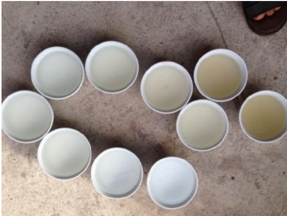
Hình 14: Chất lượng dầu ra đánh giá trực quan khi cột nước H từ H=80cm đến H=0 cm.
