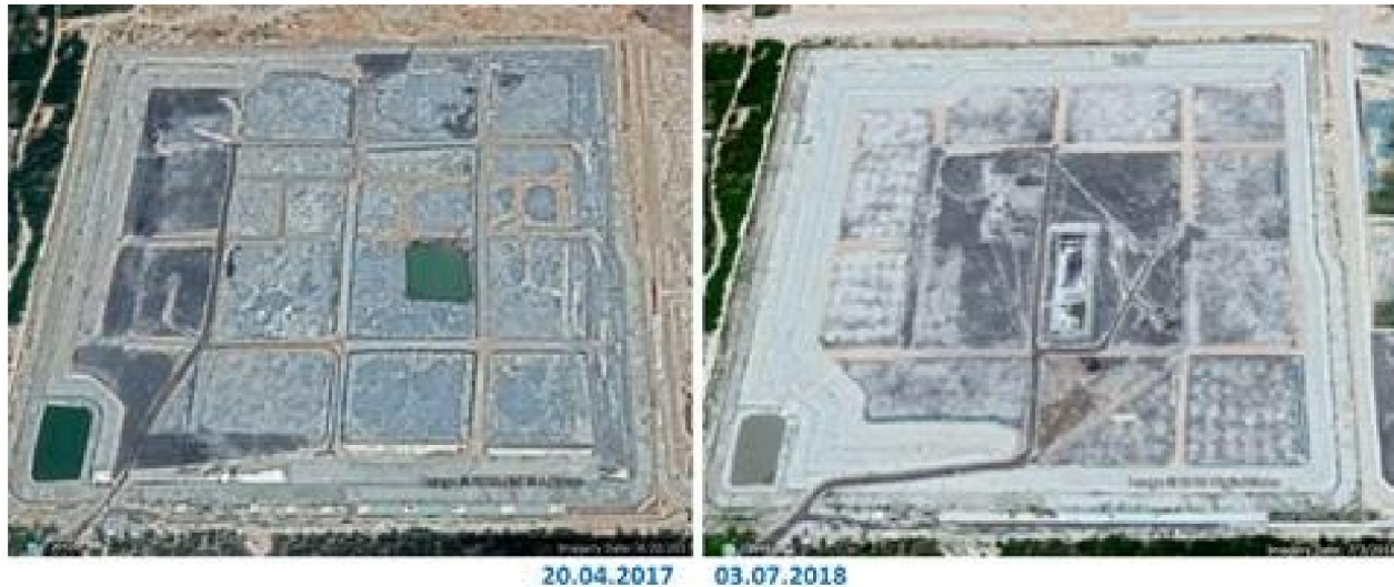
Hình 6. Sau 15 tháng, bãi xỉ Vĩnh Tân đã phải nâng thêm một tầng bờ bao
