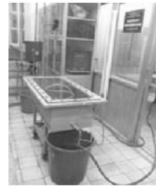
Hình 2: Mô hình TN xói ngầm; (a) Sơ đồ đơn giản; (b) Sơ đồ bố trí TN trong phòng
