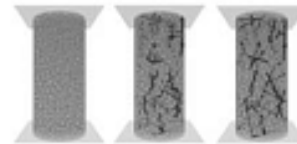
Hình 6. Mô phỏng nén 3 trục mẫu cát và mẫu cát trộn vật liệu sợi gia cố [7]
