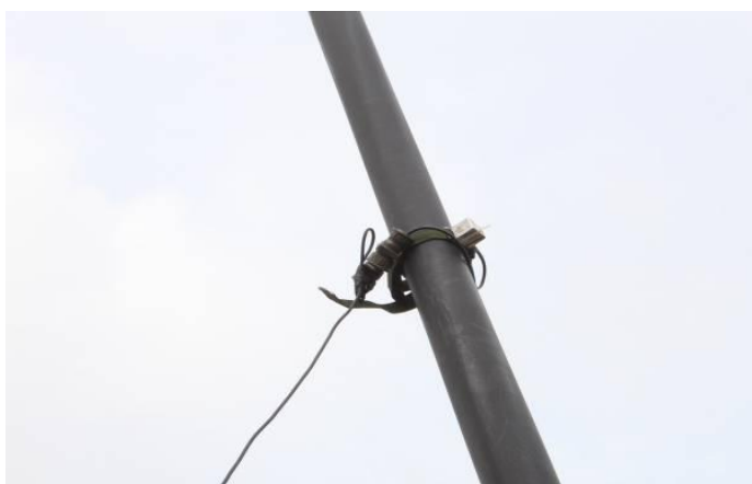
Hình 5: Thiết bị đo dao động cáp dây văng và đo dao động bằng thiết bị chuyên dụng
