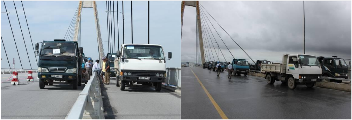
Hình 6: Xếp hoạt tải thử đo lực căng trong dây văng
