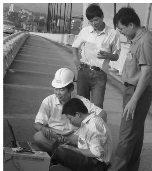
Hình 5: Thiết bị đo dao động cáp dây văng và đo dao động bằng thiết bị chuyên dụng
