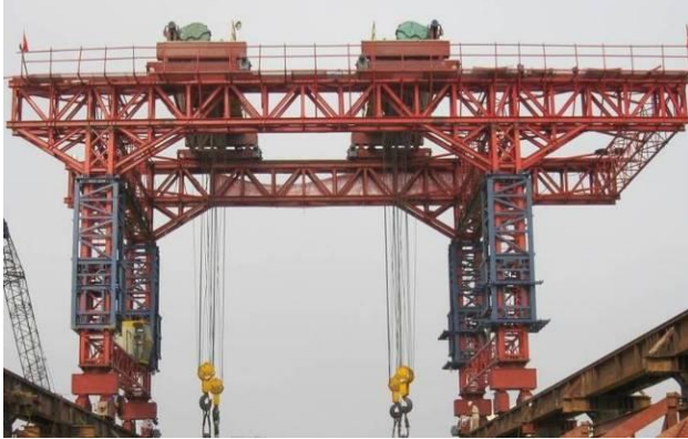
Hình 7: Long môn thi công dầm
