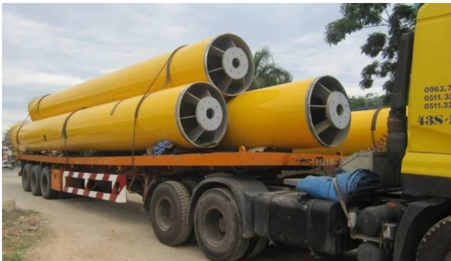
Hình 13 : Vận chuyển vòm từ xưởng ra cầu cảng.
