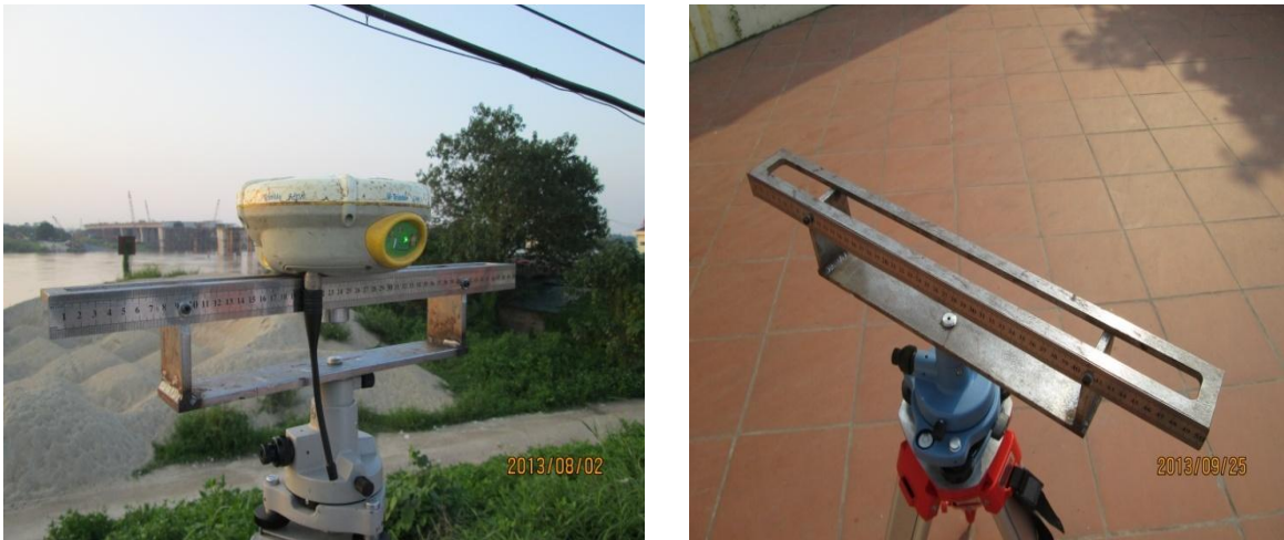
Hình 4: Thước trượt mm tự chế
