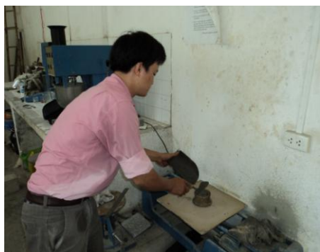
Thí nghiệm độ chảy trong côn vữa
