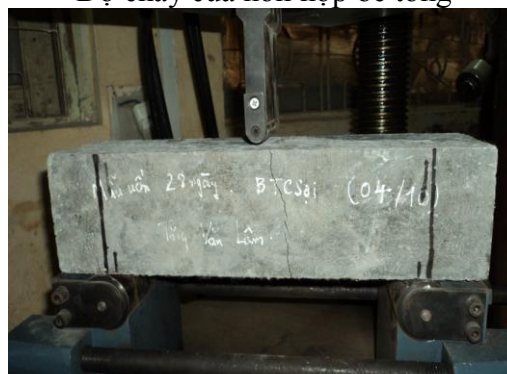
Mẫu bê tông thí nghiệm kéo khi uốn
