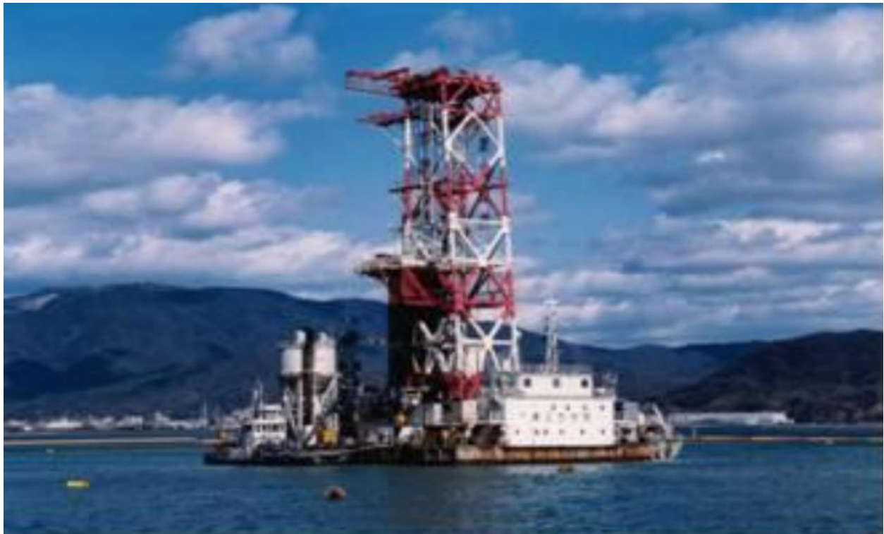
Hình 3.4. Máy CDM cho các công trình biển
