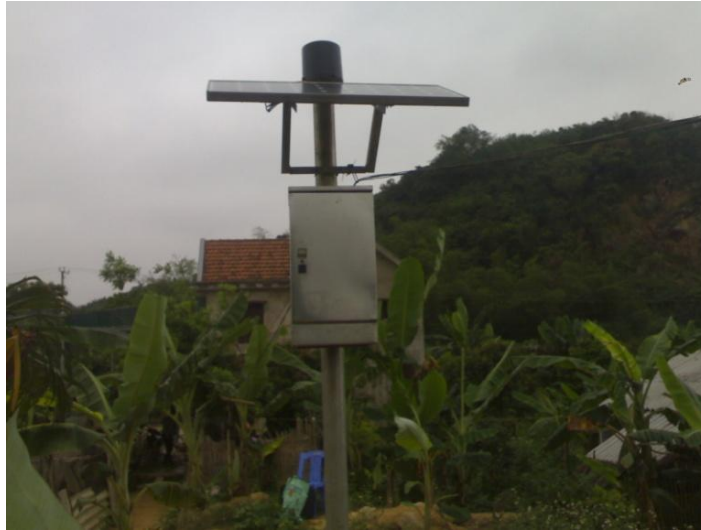
Hình 2 – Trạm đo mưa tự động.
