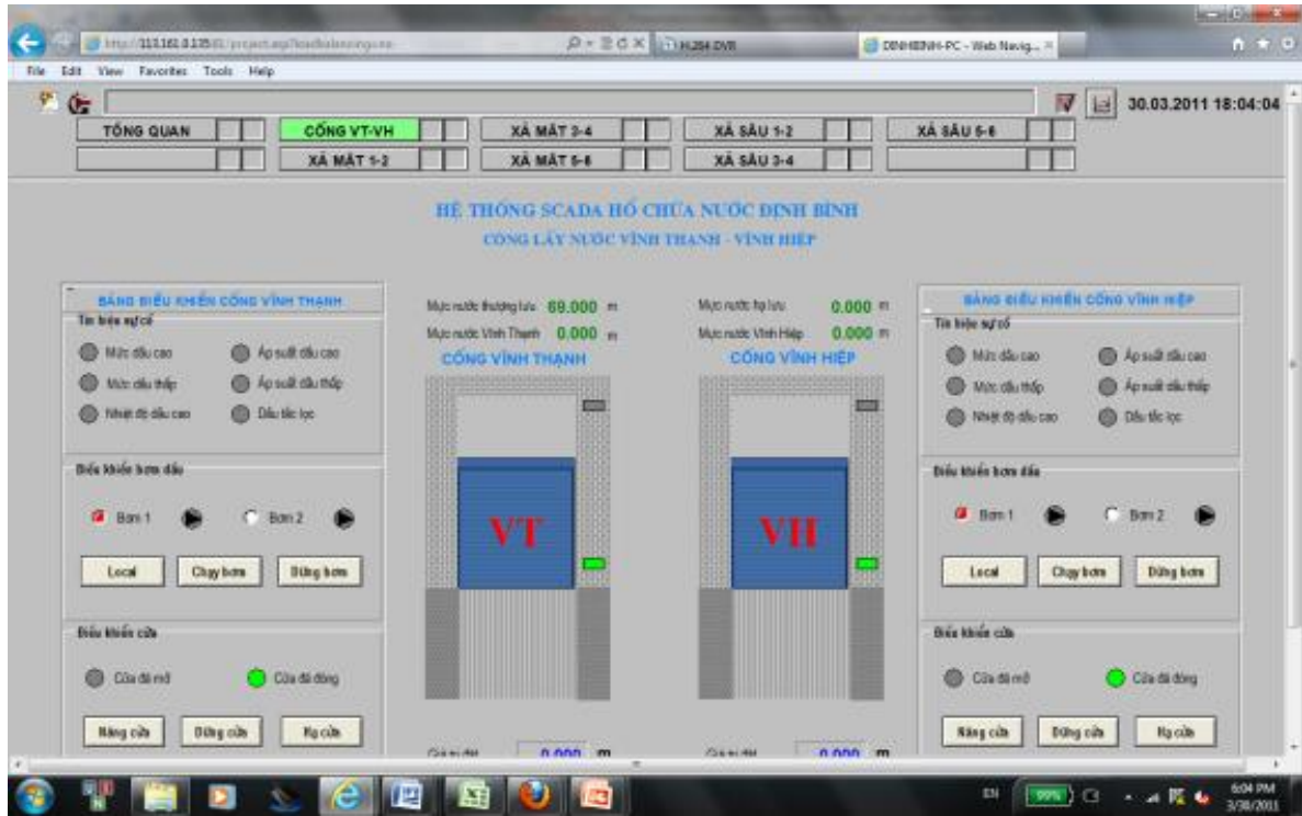
Hình 8 – Phần mềm giám sát và điều khiển hệ thống tại chỗ tại chỗ và từ xa.
