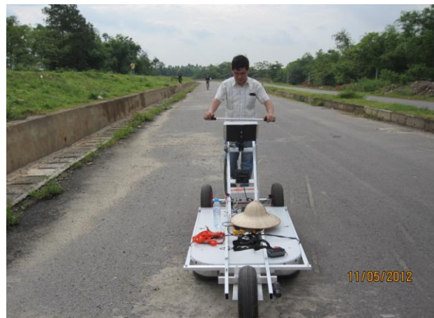
Công nghệ rada khảo sát mặt đất đang được thử nghiệm tại đề Sen Chiêu (Hà Nội)
