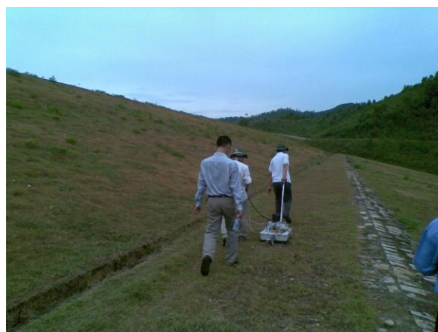
Công nghệ rada khảo sát mặt đất đang được thử nghiệm tại đập Phú Ninh (Quảng Nam)
