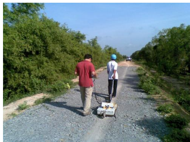
Công nghệ rada khảo sát mặt đất đang được thử nghiệm tại đề Sa Rài (Đồng Tháp).
